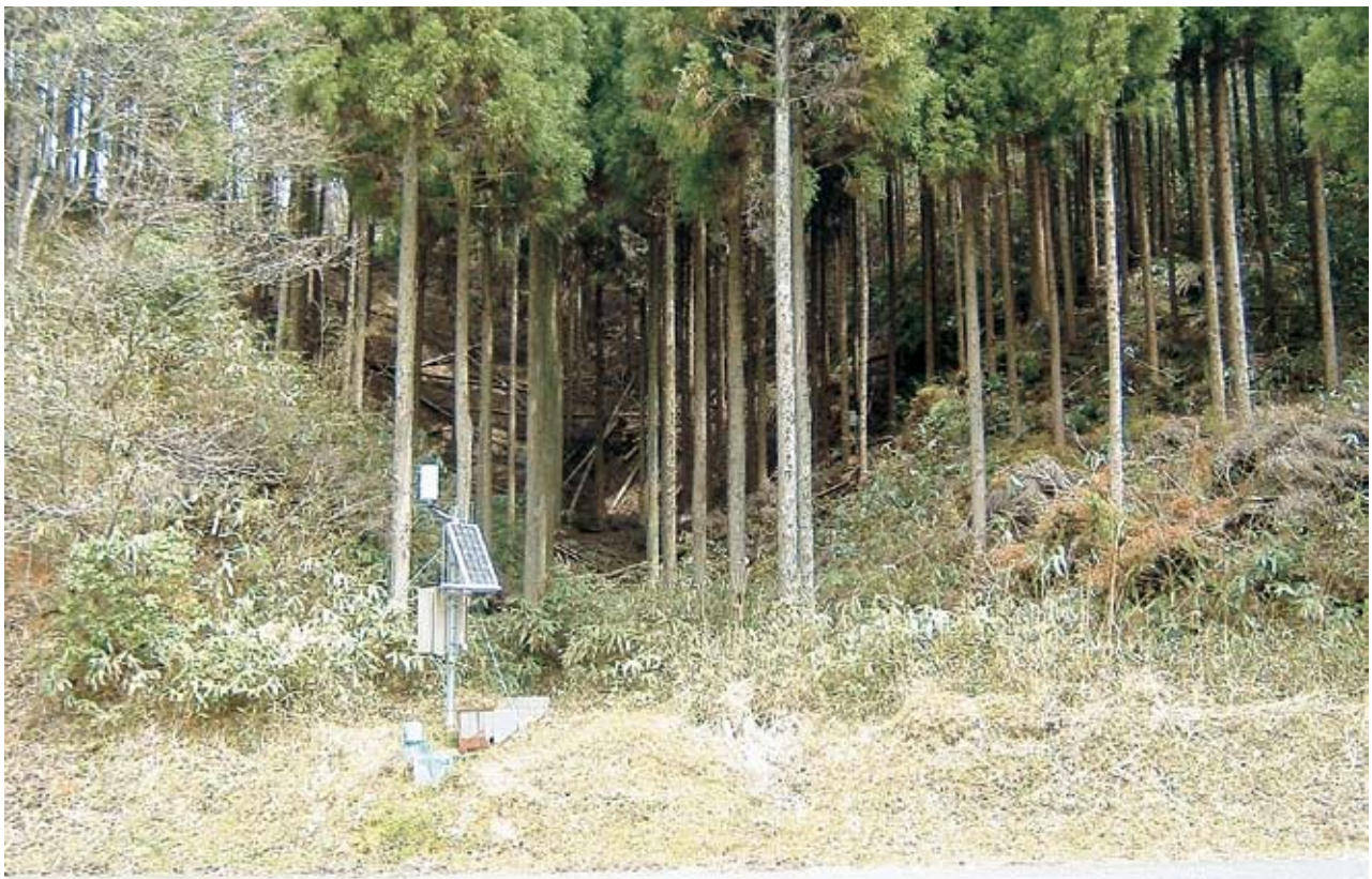
針葉樹人工林の試験流域と水文観測施設
