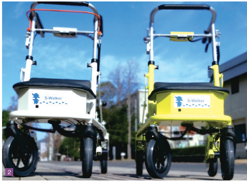
1・2. 廣富研究室で開発した、ブレーキアシスト付き歩行車「S-Walker」。歩行者との距離、歩行速度をセンサにより計測し、一人一人の歩き方に合わせたブレーキをかけるアシスト機能を備える。3. 令和元年8月にくにびきメッセで開催された「DISわぁんど in 山陰 まつえ」に出展し、ブレーキアシスト歩行車をPR。4. 前腕支持タイプの歩行車。
