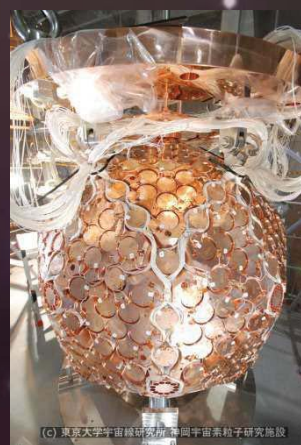
大質量のキセノンで暗黒物質の検出を目指す 「XMASS」検出器
